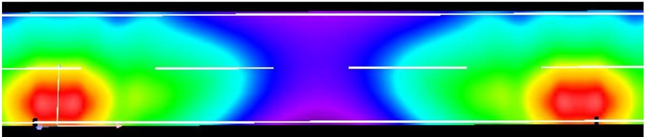
**2. Sanierungsstufe:** neue Masthöhe 5 m, 9 W LED-Leuchte mit einem Lichtstrom von 950 Lumen bei 100% Leistung
