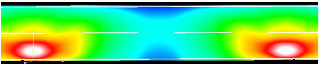
**2. Sanierungsstufe:** neue Masthöhe 5 m, 9 W LED-Leuchte mit einem Lichtstrom von 950 Lumen bei 30% Leistung ab 22:30 Uhr
