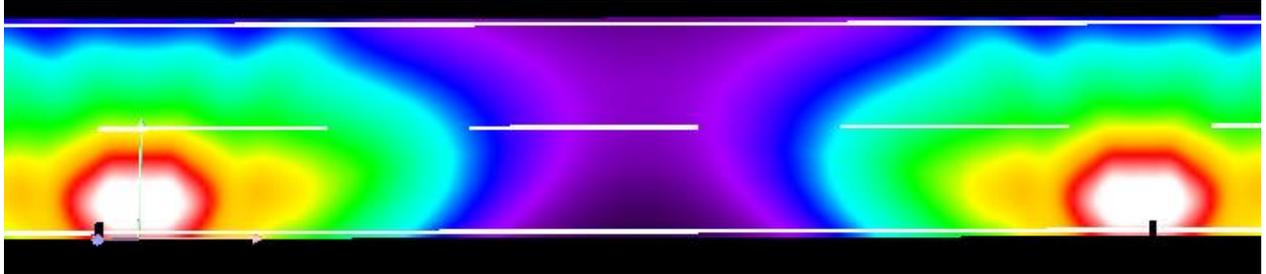
**1 Sanierungsstufe:** neue Masthöhe 5 m durch Einsatz einer Mastverlängerung, 27 W Energiesparlampe mit einem Lichtstrom von 1.800 Lumen
